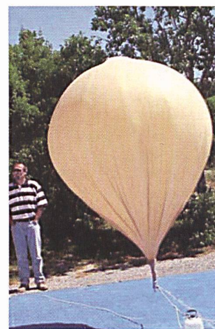
Eine Ozonsonde für Atmosphärenmessungen wird von einem Wetterballon in Höhen bis zu 35 Kilometer getragen (Foto: Empa/CNRS).
