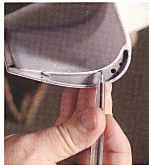
Gasturbinenschaufeln werden von innen mit einem Luftstrom gekühlt (Foto: Siemens).
