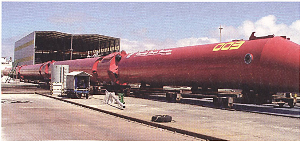
Montage der röhrenförmigen Pelamis-Segmente auf der Werft.
