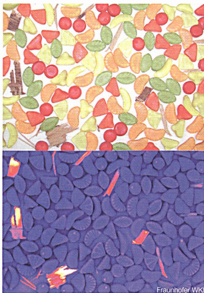
Fremdkörpererkennung in Weingummis: Im Thermografiebild (unten) lassen sich die Fremdkörper (Holzsplitter) aufgrund der abweichenden Wärmekapazität wesentlich leichter detektieren
