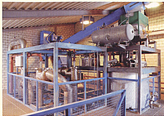
Durch die Einspeisevorrichtung gelangen die Holzschnitzel in den Holzvergaser (Bild: ekz).
