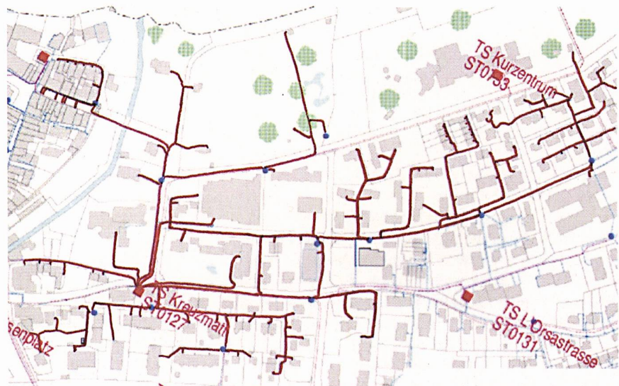
Bild 4 Netzplanausschnitt der Niederspannungsversorgung ab der Trafostation Kreuzmatt, Rheinfelden.
