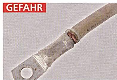
Hervortreten des blanken Leiterseils an gebrochener Seileinführung
