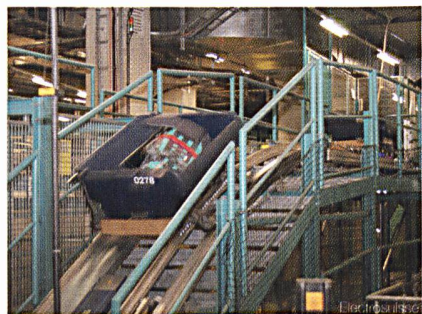
Linearmotoren treiben diesen Gepäckbehälter an – ein Teil der 20 km Bänder und Sortieranlagen zwischen Check-in und Flugzeugrumpf
