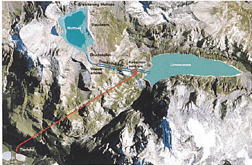
Übersicht über die Erweiterungsbauten beim Projekt Linthal 2015.
