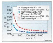
Bild 3 Drehzahlabhängiger Verlauf des thermischen Widerstands Gehäuse-Umgebung
