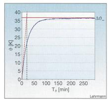
Bild 6 Grafische Bestimmung der thermischen Zeitkonstante eines Maschinenteils über die Tangenten-
