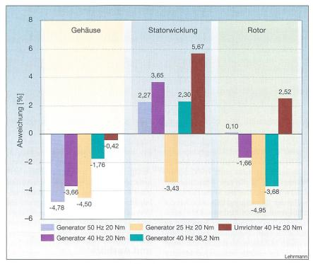
Bild 7 Abweichung zwischen gemessenen und berechneten Temperaturen
