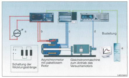
Bild 2 Versuchsaufbau zur Ermittlung des thermischen Widerstands Gehäuse-Umgebung
