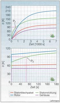
Bild 8 Temperaturverlauf der Maschine mit 1,5-fachem Bemessungsstrom
