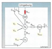
Bild 4 Thermisches Maschinen-Ersatzschaltbild
