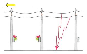
Fehlerstromanzeigegeräte Easergy verbessern die Qualität von MS-Netzen hauptsächlich durch den verminderten Zeitaufwand für das Lokalisieren von Fehlern
