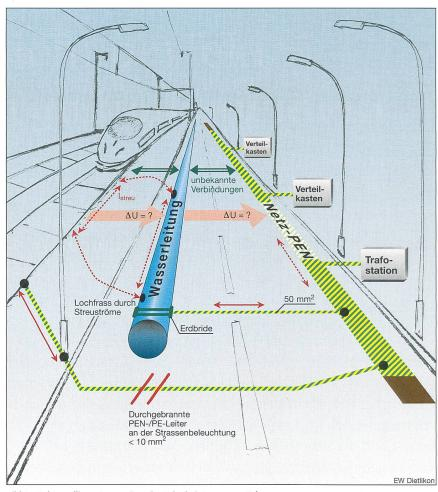
Bild 1 Unkontrollierte Streuströme der Bahn bei getrennten Erdsystemen
