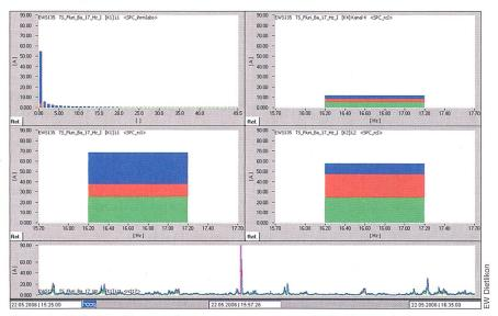
Bild 3 Wie sich der Bahnrückstrom in der Transformatorenstation des EW Dietlikon verteilt 58 A (Mitte rechts) fliessen in die Erdungsschirme der Mittelspannungskabel, der Rest von 12 A (im Bild oben rechts) in die Netz-PEN-Leiter der NS-Kabel
