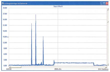
Bild 7 Bahnrückströme, die in die Lichtsignalanlage fliessen
