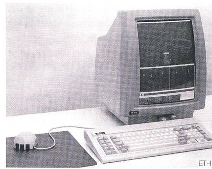
Die Lilith der ETH Zürich hatte 1980 schon vor dem ersten Macintosh eine Maus und Fenster auf dem Bildschirm
