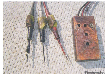
Figure 2 Pointes d'essai carbonisées du contrôleur du champ tournant
