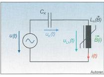
Bild 2 Ersatzschaltbild des einfachstmöglichen Ferroresonanzkreises
