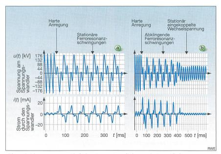
Bild 3 Beispiele von gemessenen einphasigen Ferroresonanzschwingung mit 16½-Hz-Schwingungen
