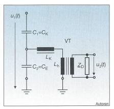
Bild 7 Prinzipschema eines kapazitiven Spannungswandlers
