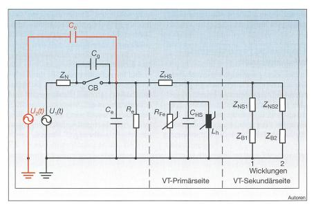
Bild 6 Ersatzschaltbild zur theoretischen Analyse einer einphasigen Ferroresonanzschwingung
