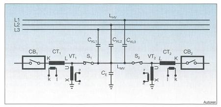
Bild 5 Ersatzschaltbild einer zur einphasigen Ferroresonanz neigenden Netzsituation, bei welcher die Schwingungen über die kapazitive Kopplung von Freileitungssystemen angeregt und aufrechterhalten werden können
