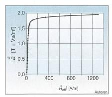
Bild 1 Beispiel einer typischen Magnetisierungskennlinie eines ferromagnetischen Kerns
