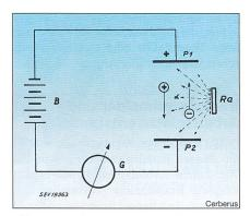
Bild 1 Prinzipschema einer Ionisationskammer
