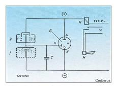
Bild 2 Prinzipschema des Ionisationsfeuermelders
