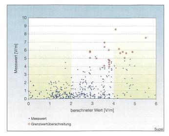
Bild 3 Gegenüberstellung zwischen Messwerten und berechneten Werten
