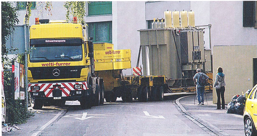
Eine 530 PS starke Sattelzugmaschine zog den sechssachsigen Tiefgangaufleger mit der schweren Last nach Liestal. Manchmal wurde es dem 26,6 Meter langen Schwertransport etwas eng (Bild: ebl).
