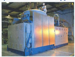
Brennstoffzellenanlage (Bild Siemens).
