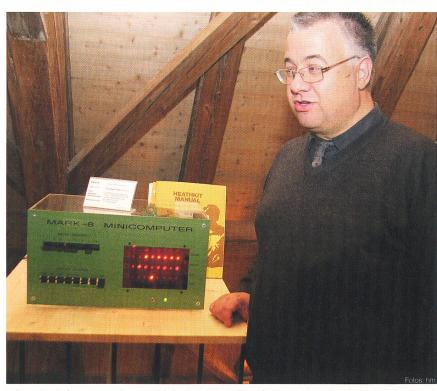
Felix Kunz mit dem von Jon Titus entwickelten Mark 8 aus dem Jahr 1973. Erster Mikroprozessor auf Computerbasis. CPU: Intel 8008, 8 Bit, 800 kHz, 1 KB RAM, EEProm 2 KB. Die Eingabe erfolgte mittels Schaltern in Oktal, die Ausgabe mit LED-Anzeigen. Verwendung: Steuerung und Ausbildung in Maschinensprache.
