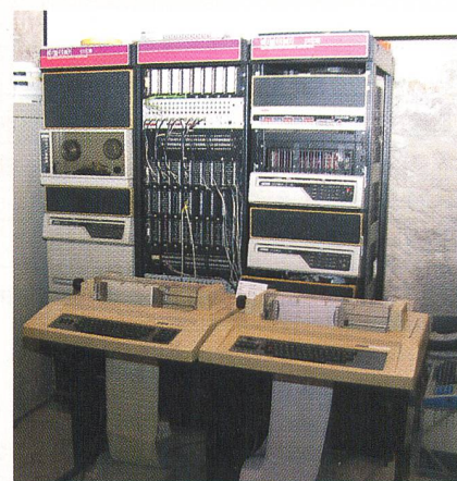
Dieser DEC DPD 11/34, Baujahr 1976, mit Magnetkernspeicher, ist immer noch funktionstüchtig, wie fast alle Rechner im PC-Museum Solothurn. Im Einsatz bei den Bernischen Kraftwerken (BKW) bis in die 90er-Jahre.
