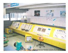
Figura 1 Simulatore della rete elettrica di Friburgo Rete 220/60 kV riportata a 3x400 V
