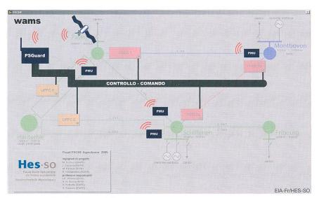
Figura 7 WAMS per la protezione della rete
