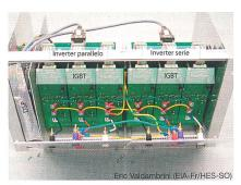
Figura 3 Elettronica di un UPFC Vista del UPFC sviluppato alla EIA-Fr
