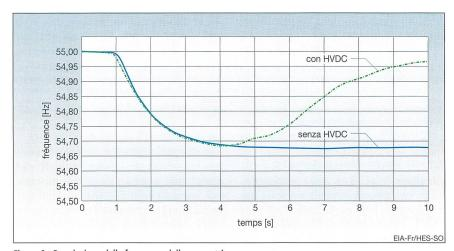
Figura 6 Regolazione della frequenza della generatrice
