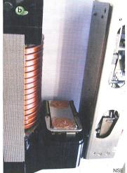
Bild 1 Innenleben eines Primärschutzgeräts
