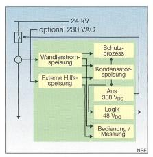
Bild 3 Konzept Wandlerstromversorgung und Kondensatorspeisung (Triple Powered)
