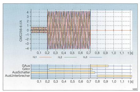
Bild 4 Abschaltzeiten des Systems mit Schutz und Schalter (Digimut)
