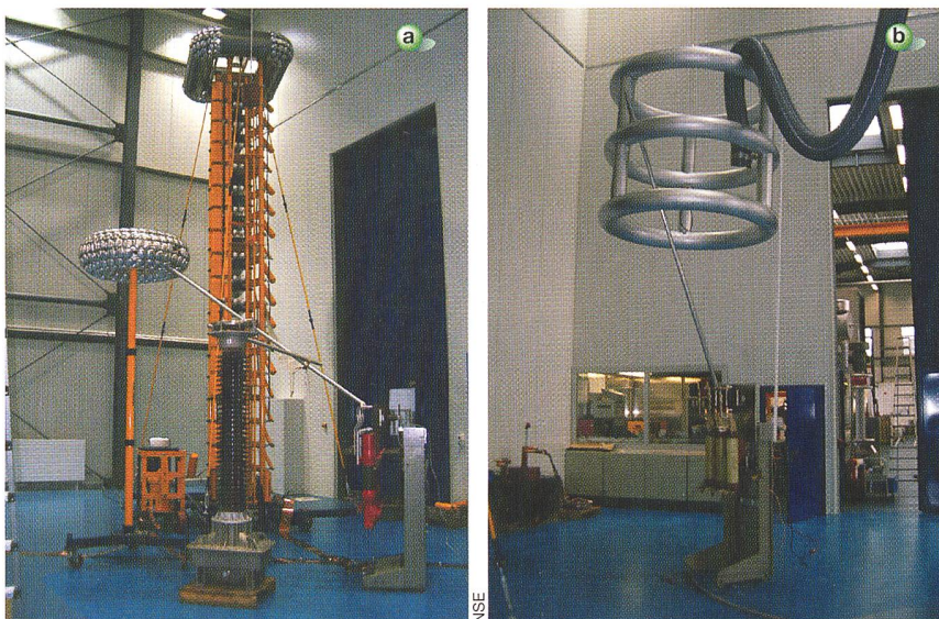
Bild 7 Prüfungen des Schalters für 12/24 kV
