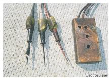
Bild 2 Verkohlte Messspitzen des Drehfeldprüfers
