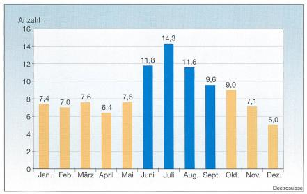
Bild 6 Elektroberufsunfälle nach Jahreszeit (Durchschnitt aus den Jahren 1996–2005) Auffallend ist die Häufung der Elektrounfälle im Sommer
