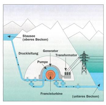
Stromerzeugungsarten zur Verfügung: Speicherkraftwerke mit oder ohne Pumpspeicherung und Gasturbinen.
