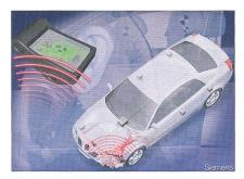
Der neue Airbagsensor nimmt nicht nur die Beschleunigungskräfte auf, sondern hört den Unfall auch und kann damit schneller entscheiden, ob er den Airbag auslösen soll
