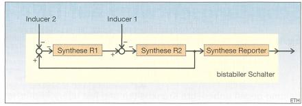
Bild 2a Blockdiagramm für einen bistabilen Schalter
