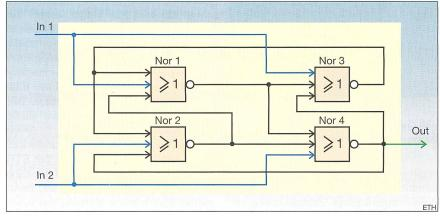
Bild 5b Speichereinheit aus 4 Nor-Gattern
