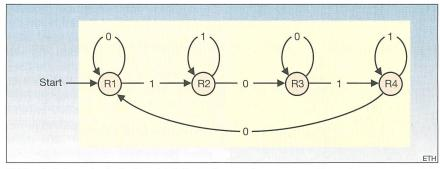
Bild 5a Funktionsweise der Speichereinheit (Zustandsautomat)
