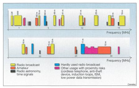
Figure 4 Allocation des fréquences de la bande HF
