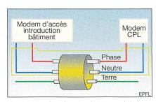
Figure 6 Couplage d'un signal CPL en mode indoor
