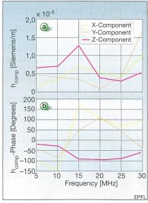
Figure 12 L'amplitude et la phase de fonction h<sub>comp</sub>(f) calculées en fonction de la fréquence en utilisant une tension de source d'amplitude égale à 1 V et de phase égale à 0 pour la configuration de Figure 10
