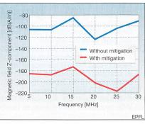
Figure 13 Composante z de champ magnétique en fonction de la fréquence, déterminée avec et sans l'application de la méthode de réduction
