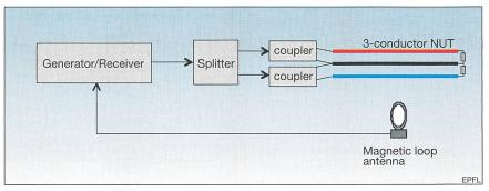
Figure 8 Montage utilisé pour les mesures des champs rayonnés avec le système de réduction
