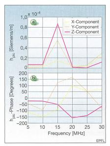
Figure 11 L'amplitude et la phase de fonction h<sub>plc</sub>(f) calculées en fonction de la fréquence en utilisant une tension de source d'amplitude égale à 1 V et de phase égale à 0 pour la configuration de Figure 10
