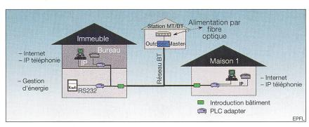
Figure 1 Principe d'un réseau CPL basse tension
