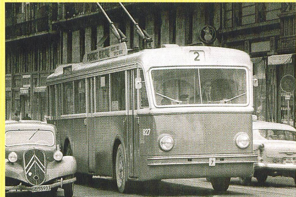
Pioniere: Seit 1942 werden in Genf Trolleybusse mit Alu-Karosserien von Hess eingesetzt (Trolleybus Saurer 1950; Bild: Archiv TPG).
