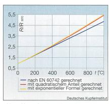
Bild 5 Abhängigkeit des Widerstands von der Temperatur für Kupfer, gerechnet nach drei verschiedenen Verfahren
