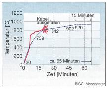
Bild 4 Prüfkurve und praktischer Prüfverlauf eines brandbeständigen Kunststoffkabels
