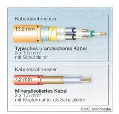
Bild 6 Grössenvergleich herkömmliches und mineralisoliertes Brandsicherheitskabel
