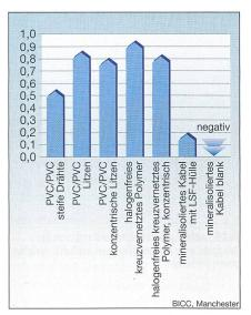
Bild 3 Brandlast einiger Kabel und Leitungen
