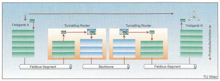
Bild 3 Tunnelling Router
