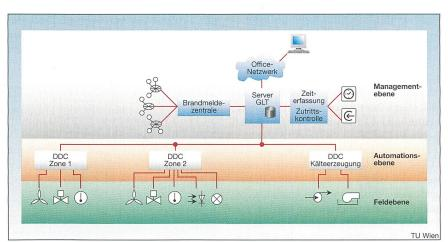
Bild 1 Schichtenmodell der Gebäudeautomation
