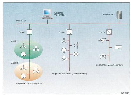
Bild 2 Automationsnetzwerke und Backbone
