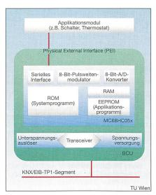
Bild 5 KNX/EIB-Gerät
