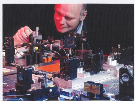
Justierung des Femtosekunden-Kammgenerators der Ytterbium-Atomuhr
