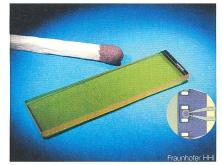
Polymerchip mit Mikrospektrometer: Auf dem Chip mit winzigen Leiterbahnen aus Kunststoff sind Fotodioden aus Indiumphosphid integriert
