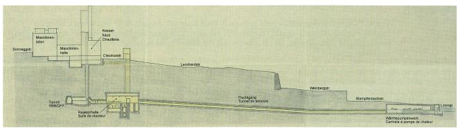
Lageplan des geplanten Reaktors: Links oben das Maschinen-Labor, unten rechts die Limmat. Das Kesselhaus war direkt oberhalb der Clausiusstrasse geplant.
