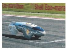
Der PAC-Car II während dem Shell-Eco-Marathon in Nogaro: Mit dem Äquivalent von einem Liter Benzin hat das Brennstoffzellen-Fahrzeug auf seiner Rekordfahrt 5134 Kilometer zurückgelegt.
