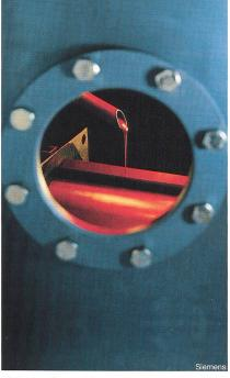
Bild 5 Da die Epoxidharzisolierung der Oberspannungswicklung unter Vakuum vergossen wird, entstehen keine Gaseinschlüsse
