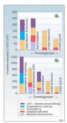
Bild 4 Investitionskosten verschiedener Notstromanlagetypen
