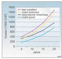
Bild 6 Kostenvergleich der verschiedenen Notstromanlagetypen über mehrere Jahre
