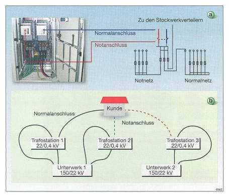
Bild 2 Redundanter Anschluss
