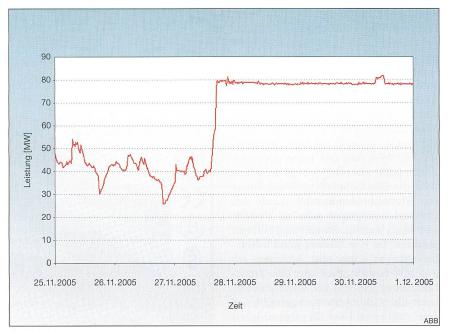
Bild 6 Inbetriebnahme des Querregeltransformators
