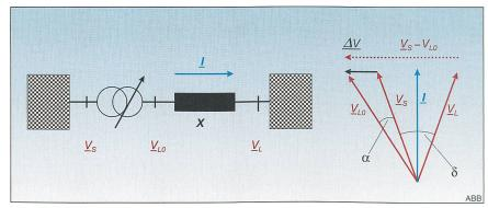
Bild 3 Kopplung über einen Querregler
