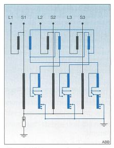
Bild 4 Schaltbild des Querregeltransformators Oben der Serientransformator, unten der Erregertransformator mit Stufenschalter mit Grob/Fein-Wähler
