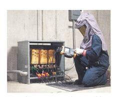
Netz- und Stromversorgungsanalysator von Fluke im Einsatz
