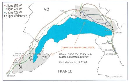
Figure 2 Emplacements des zones privées d'alimentation électrique.
