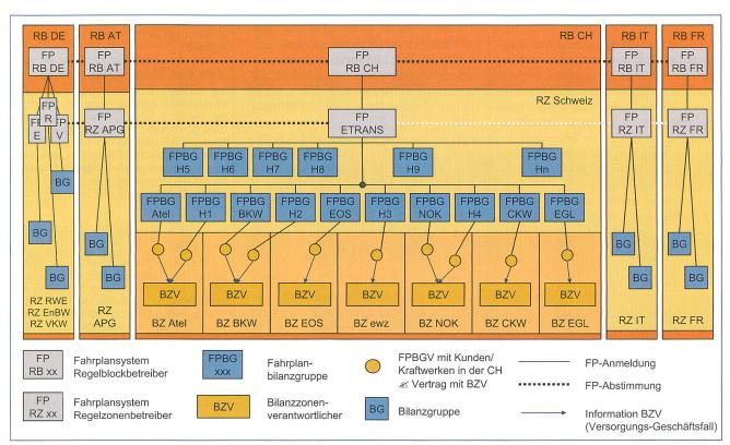
Bild 1 Überblick über das neue Fahrplanbilanzgruppensystem (FPBG-System).
