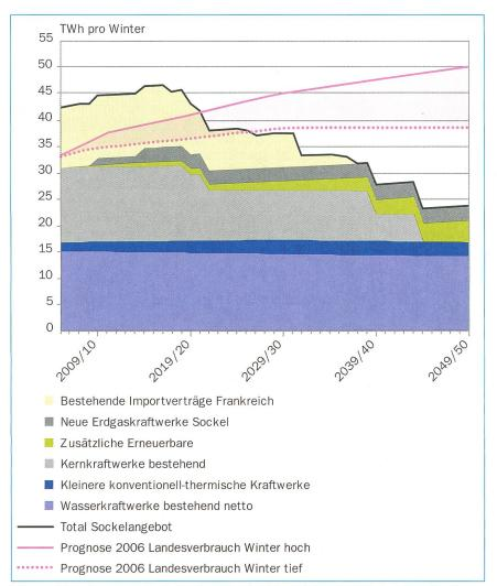
Bild 2 Nachfrageprognose und Sockelangebot Winterhalbjahr. Sockelangebot: existierende Kraftwerke und Langfristverträge, Zubau Erneuerbare, Erdgaskraftwerke (800 MW) und diverse Kleinanlagen, einzelne Leistungssteigerungen Wasserkraft.
