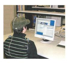
über in der Dachmütze integrierte Beschleunigungssensoren die Kopfbewegungen. Über weitere, am Körper angebrachte Sensoren können die linke und die rechte Maustaste bedient werden. Aufgrund der erfassten Daten wird der Mauszeiger dann auf dem Bildschirm bewegt und nach Wunsch positioniert. Mithilfe einer Bildschirmtastatur wird der Computer so auch für Menschen mit Rückenläsionen oder mit einer Muskelkrankheit praktisch uneingeschränkt nutzbar.
