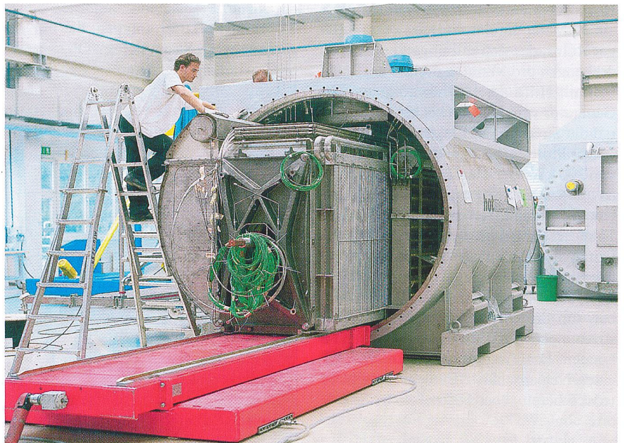
Das «HotModule» während der Produktion: Gut zu erkennen ist der charakteristische Stahlzylinder, in den der liegende Brennstoffzellenstapel eingeschoben wird. Zu den Besonderheiten des HotModules (elektrischer Wirkungsgrad etwa 47%) gehört seine Flexibilität bezüglich des verwendbaren Brennstoffs. Neben Erdgas können auch Bio- und Klärgas oder Flüssigbrennstoffe wie Methanol zum Einsatz kommen. Der Vorteil: Sekundärbrennstoffe aus Abfall oder Biomasse erlauben eine klimafreundliche Energieerzeugung. (Bild: MTU CFC Solutions)
