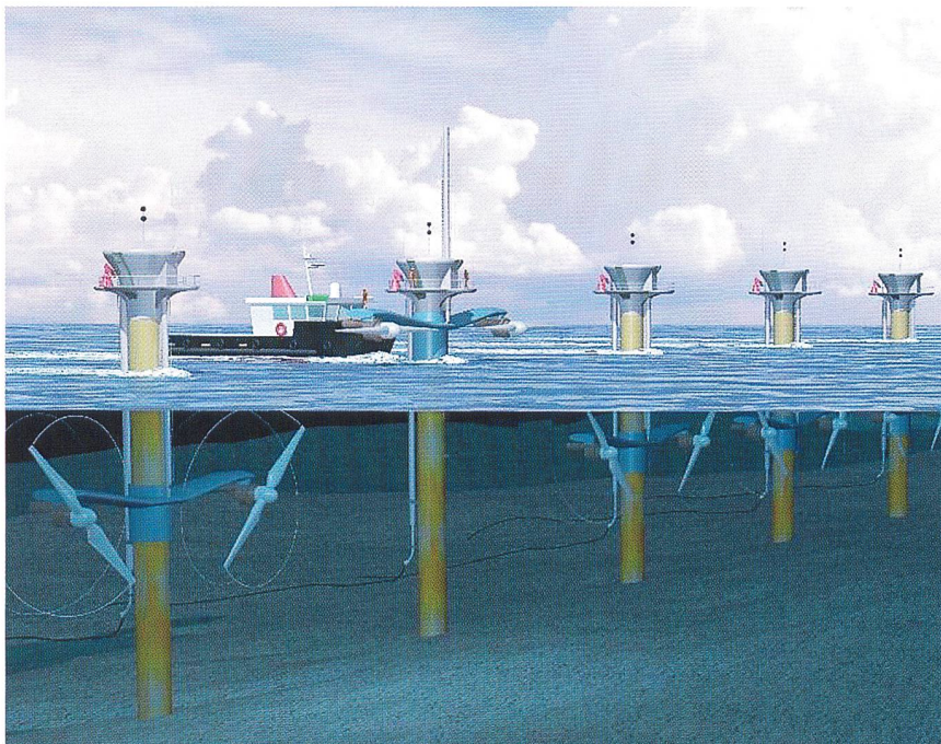
Projekt «Seagen» mit 1-MW-Doppelrotoranlagen (Marine Current Turbines).
