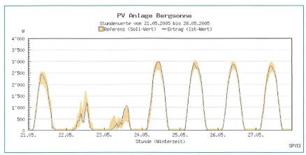
Bild 2 Energieertrag und Referenzwert einer fehlerfrei funktionierenden PV-Anlage.
