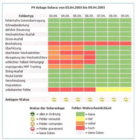
Bild 6 Resultat der FDR für ein PV-System mit Beschattung.
