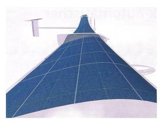
Mehrere Tage ohne jeglichen Treibstoff in der Luft, nur angetrieben von der Energie, die durch die auf den Flügeln angebrachten Solarzellen gewonnen wird.
