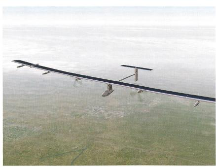
Die Spannweite des Flugzeugs wird rund 80 Meter betragen.
