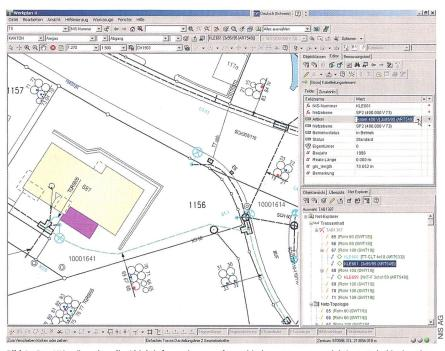
Bild 1 Das NIS präsentiert die Objektinformationen auf verschiedene Arten. Das selektierte Kabel ist in seiner Lage durch eine grüne Markierung im Grafikfenster erkennbar. Die Kabeleigenschaften sind im Objekteditor rechts oben und die Beziehungen zu anderen Objekten, wie Schutzrohr und Trassee, sind rechts unten sichtbar.
