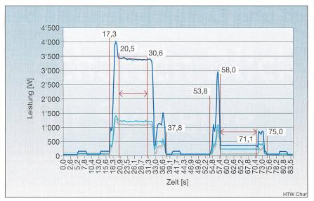
Bild 2 Messwerte der Leerfahrten eines Seilaufzugs mit Gegengewicht
