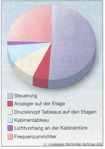
Bild 6 Beispiel für die Zusammensetzung des Stand-by-Verbrauchs
