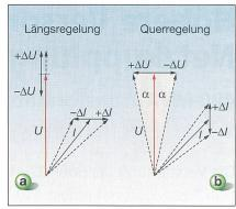
Bild 3 Längs- und Querregelung von Transformatoren (Zeigerdiagramme)
