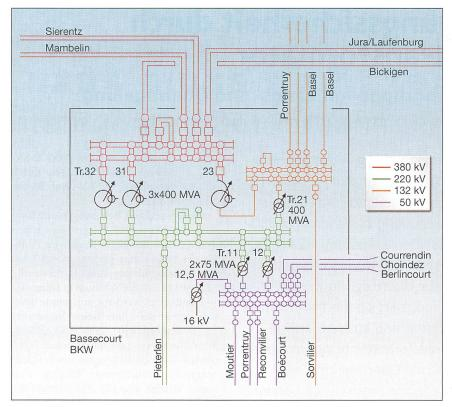
Bild 2 Netzübersicht Unterstation Bassecourt
