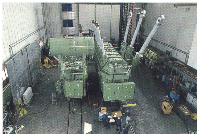
Bild 6 Prüfung der Transformatorgruppe im Werk (ohne Kühler), links der Reguliertransformator, rechts der Haupttransformator
