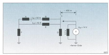
Bild 5 Vereinfachtes Ersatzschaltbild für die Erdungsmessungen bei der Transformatorenstation Meglisalp
