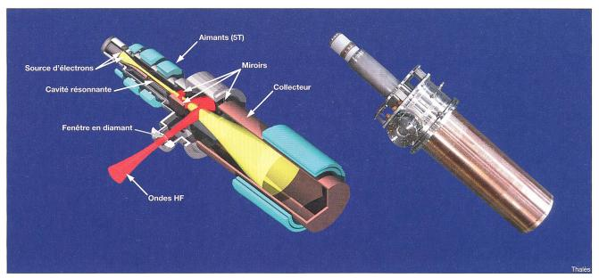
Figure 5 Gyrotron de 140 GHz (Thalès)
