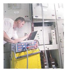
Aus der Primärprüftechnik zeigen wir Ihnen das CPC 100, das multifunktionale Prüfsystem für die Inbetriebnahme und die Wartung von Umspannanlagen. Der CT Analyzer, das ideale Werkzeug für die Prüfung von Stromwandlern, und der FR Analyzer (Swept Frequency Response Analyzer) für die Diagnose von Wicklungsdeformationen an Leistungstransformatoren runden das Produktspektrum ab.
