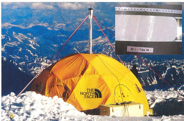
Das Bohrzelt auf dem Belukha-Gletscher. Im kleinen Bild ist der markante Temperaturanstieg sichtbar: Der Eiskern enthält durchsichtige Schmelzschichten, die sich bilden, wenn die Lufttemperatur höher als null Grad ist. Da beginnt der Schnee an der Gletscheroberfläche zu schmelzen (Fotos: PSI).
