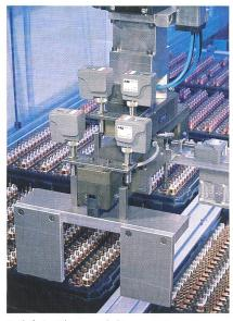
Drahtfreie Näherungsschalter von ABB
